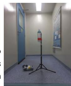
Figura 3 - Amostrador atmosférico.
